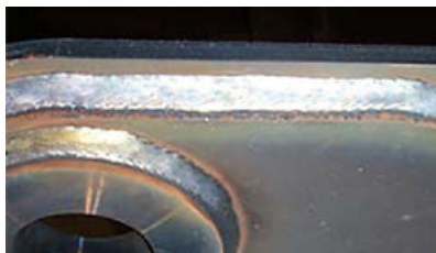
Ejemplo de correcto posicionado del hilo
