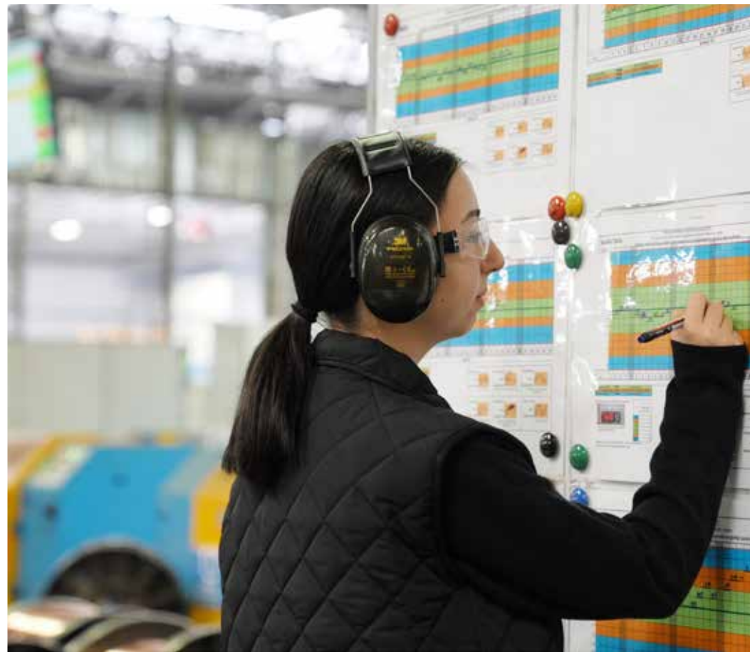
SEGUIMIENTO DE PARÁMETROS CLAVE DE PRODUCCIÓN MEDIANTE CONTROL ESTADÍSTICO DE PROCESOS
