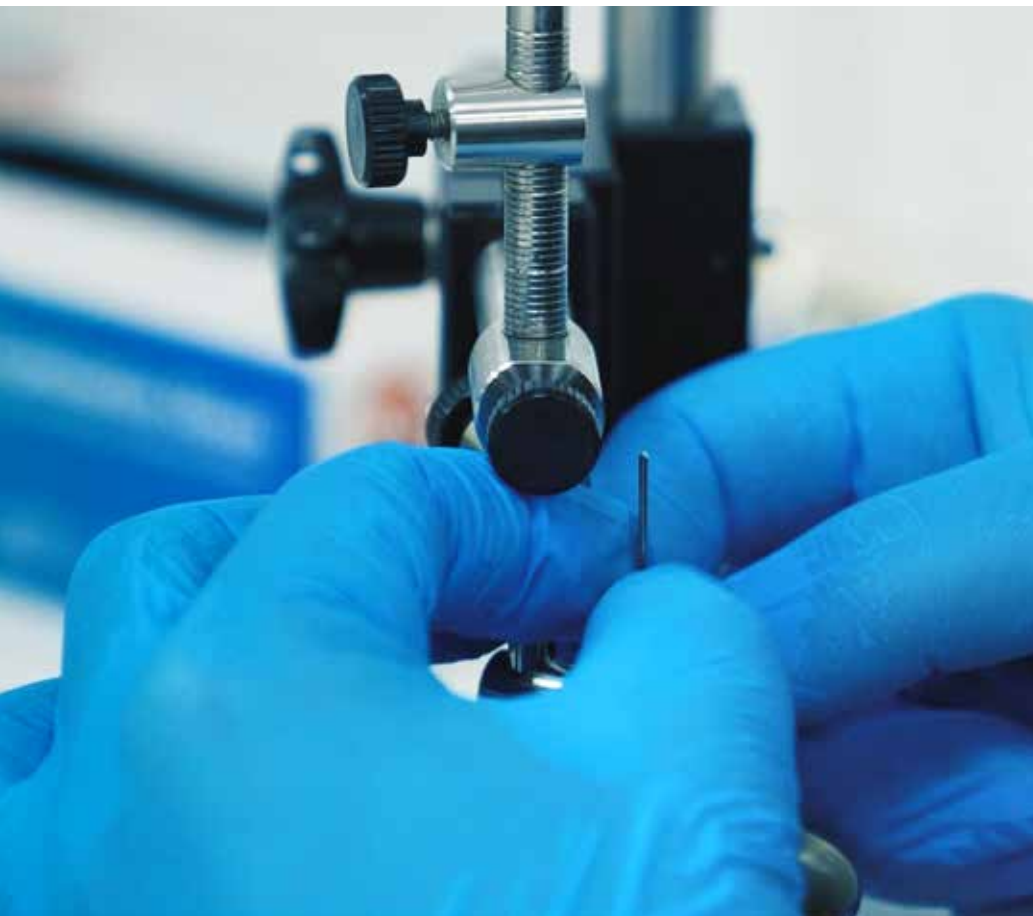
MEDICIÓN DEL ESPESOR DEL RECUBRIMIENTO DE COBRE
